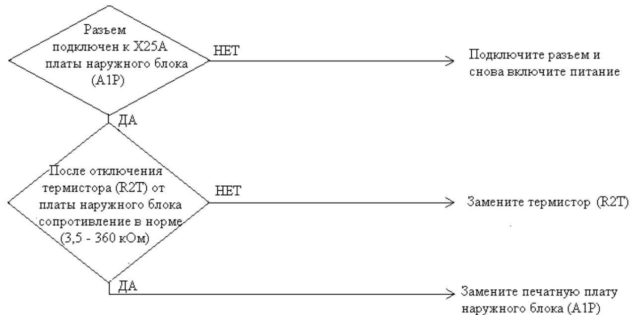
(\*) Руководствуйтесь приводимой в последующих разделах таблицей соответствия сопротивления и температуры, регистрируемой термистором.
