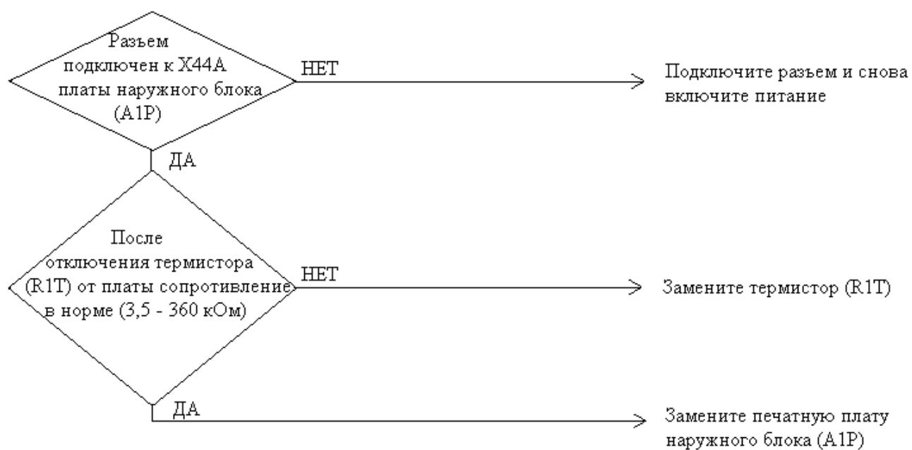
Аварийная индикация появляется только при работающем вентиляторе.
