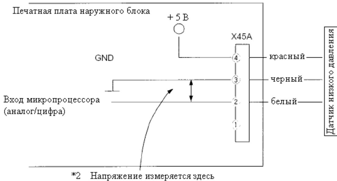
(\*) Руководствуйтесь приводимой в последующих разделах таблицей соответствия напряжения и давления, регистрируемого датчиком.
