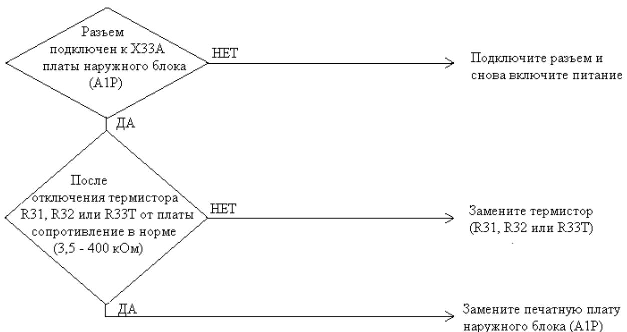
Аварийная индикация появляется только при работающем вентиляторе.
