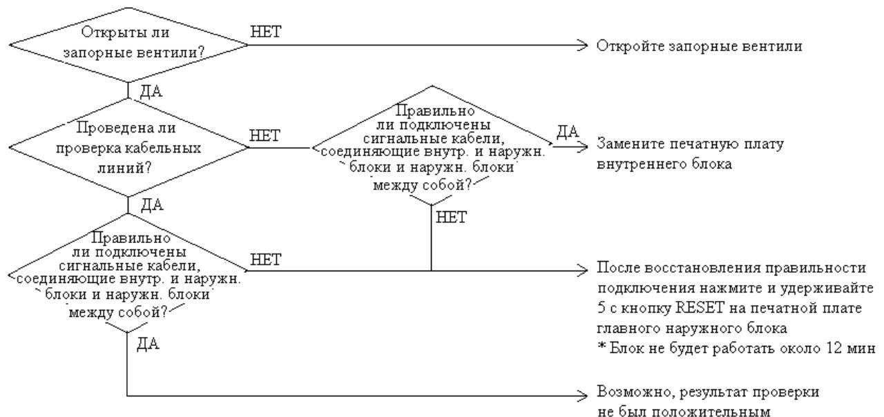
**Примечание.** Проверка может дать отрицательный результат в тех случаях, когда наружный блок не был включен заранее (не менее, чем за 12 часов) или когда все подключенные внутренние блоки не проработали не менее одного часа в режиме вентиляции.
