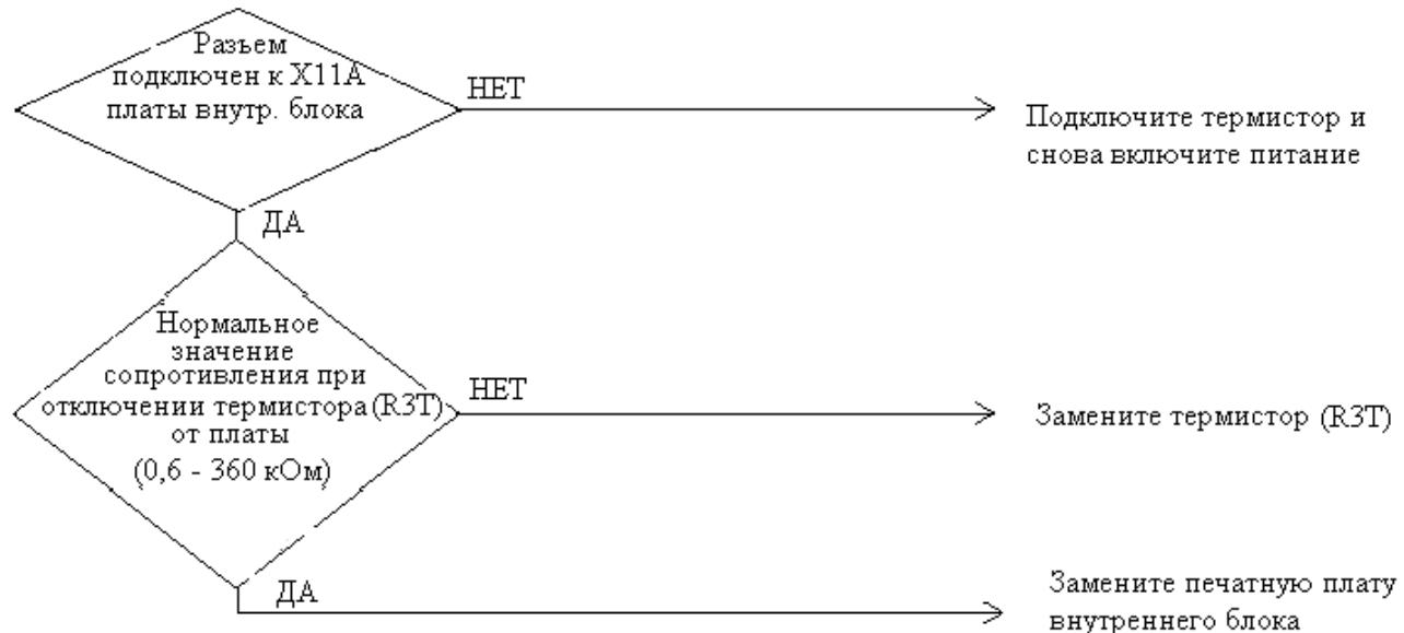
(\*) Руководствуйтесь приводимой в последующих разделах таблицей соответствия сопротивления и температуры, регистрируемой термистором.
