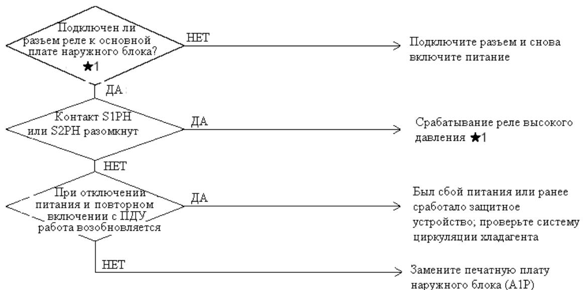
\*1) Срабатывание реле высокого давления:
