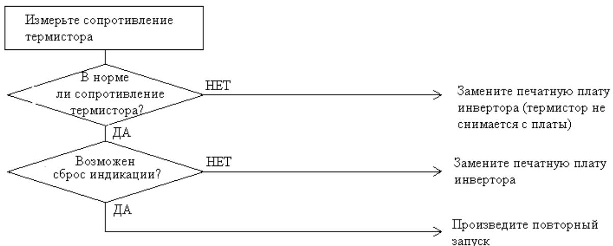
(\*) Руководствуйтесь приводимой в последующих разделах таблицей соответствия сопротивления и температуры, регистрируемой термистором.
