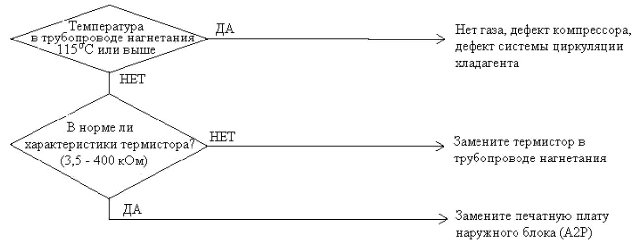
(\*) Руководствуйтесь приводимой в последующих разделах таблицей соответствия сопротивления и температуры, регистрируемой термистором.
