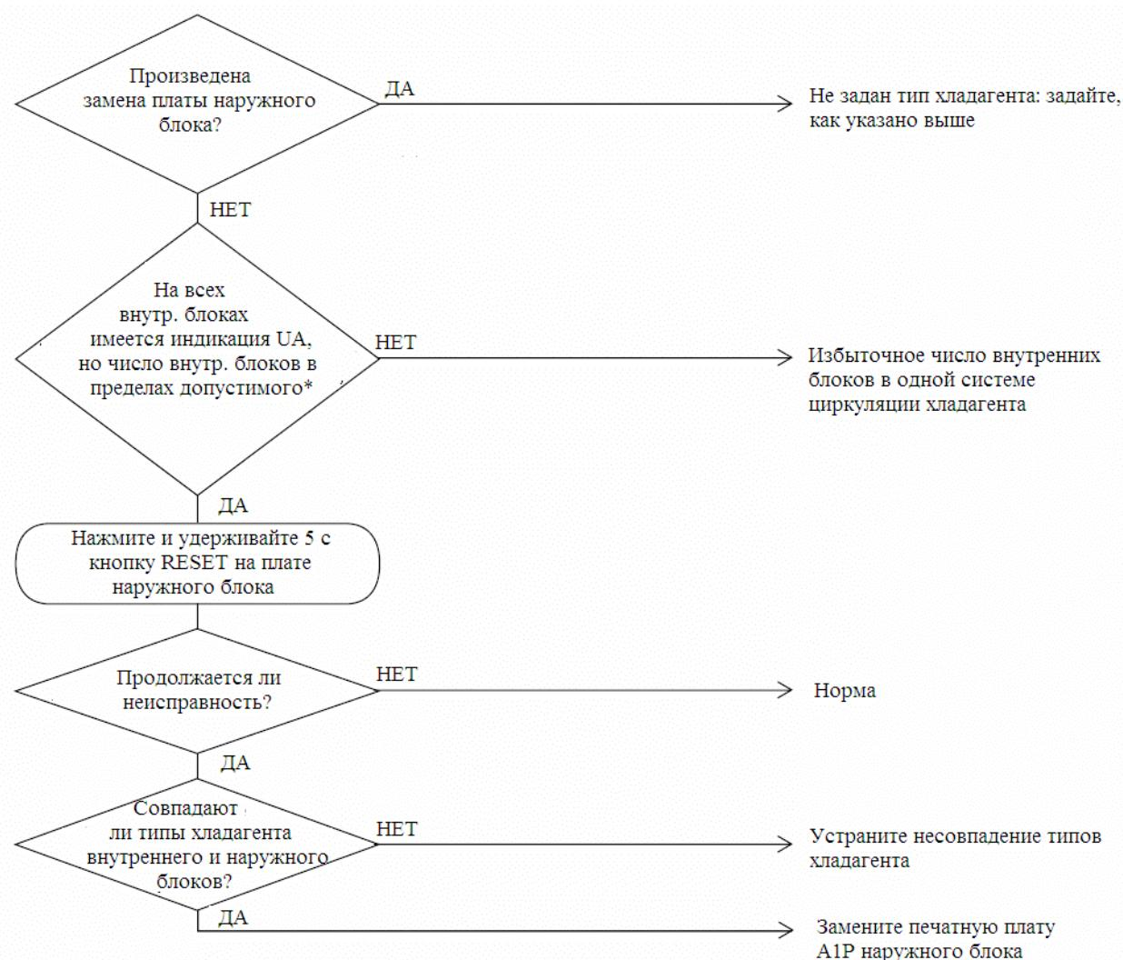
\* Число внутренних блоков, подключаемых к одному наружному блоку, определяется типом наружного блока.
