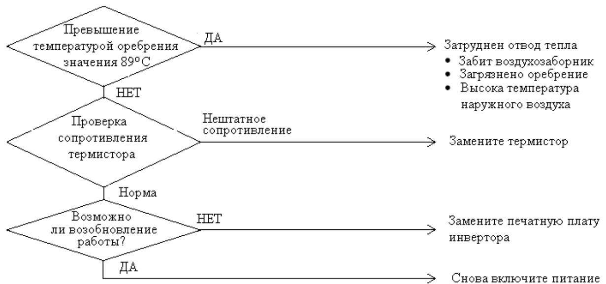
(\*) Руководствуйтесь приводимой в последующих разделах таблицей соответствия сопротивления и температуры, регистрируемой термистором.
