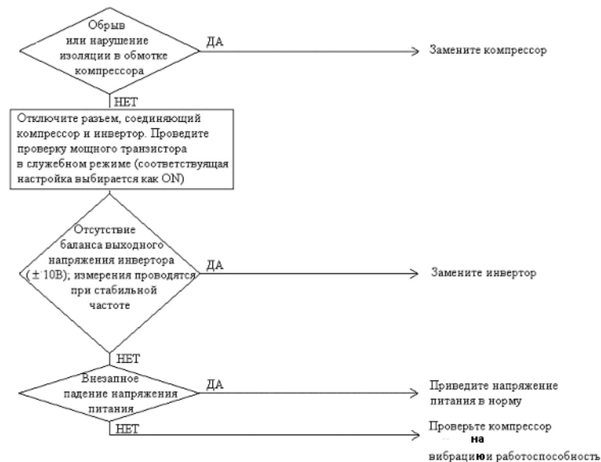
При измерении выходного напряжения инвертора тестером показания превышают истинное значение напряжения.
